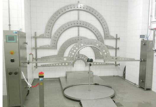
Die Integration von Wasserschutzart-Prüfungen in Ihre Räumlichkeiten haben wir beispielsweise mit der Prüfeinrichtung **IP-MASTER** realisiert. Die Einrichtung besteht aus einem Prüf- und einem Aggregaterraum. Der IP-MASTER ist für die Durchführung von IPX5, IPX6, IPX9K und Hosedown-Prüfungen (UL 50E bzw. NEMA 250) konzipiert.
